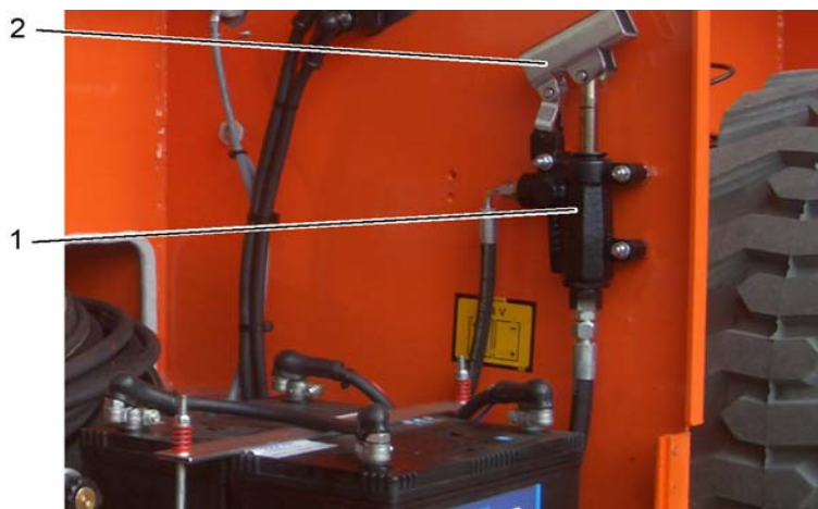
Pompe manuelle pour la partie déployée de la plateforme
